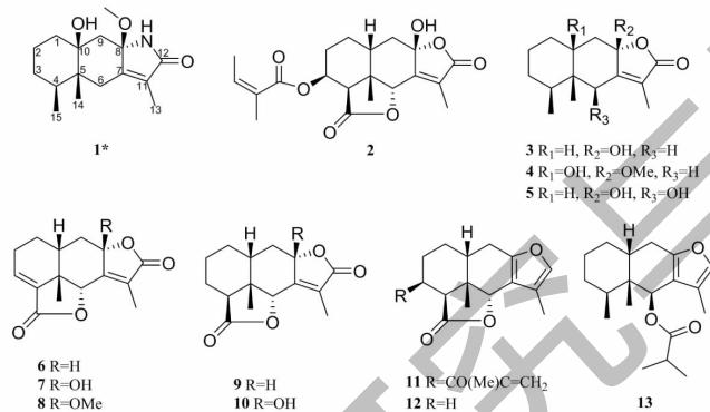
图 1 化合物 1~13 的化学结构(\* 新化合物)
